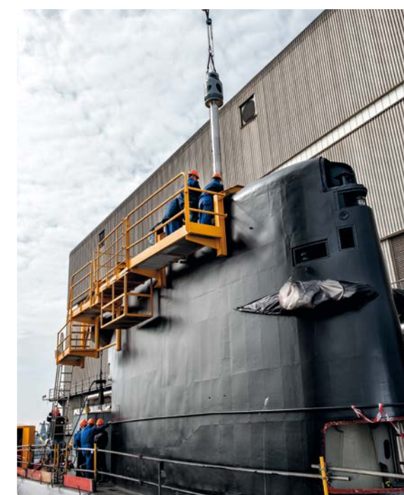
Een kraan laat de optronische mast in het sail (opbouw van een onderzeeboot) zakken.
