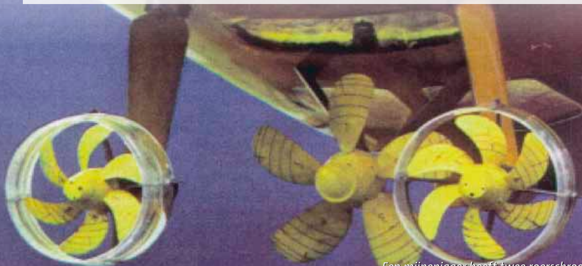
Een mijnenjager heeft twee roerschroeven (diameter 1,46 m) en een hoofdschroef van 2,5 meter.
