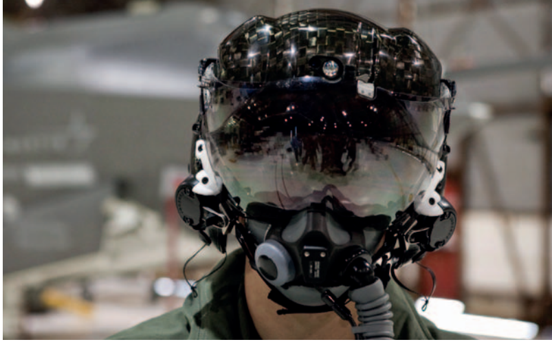
Testvlieger Speares met de speciaal voor de F-35 ontworpen helm. In plaats van een head-up display in de cockpit krijgt de vlieger alle noodzakelijke informatie op een Helmet Mounted Display geprojecteerd in deze futuristische helm.
