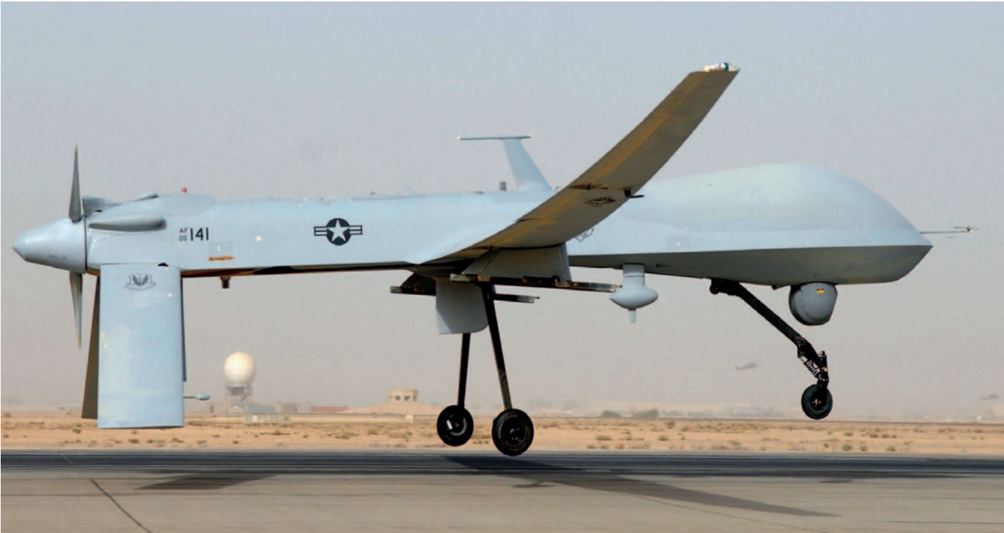
De MQ-1 Predator is – naast Israëlische UAV's – een van de weinige toestellen die voldoet aan het eisenpakket, zoals vluchtduur en (toekomstige) bewapening.
