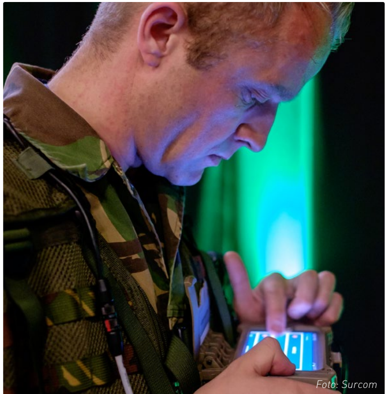
Met behulp van deze nieuwe terminal kan de Forward Air Controller in het veld een jachtvlieger via datalink zijn doel aanwijzen.
